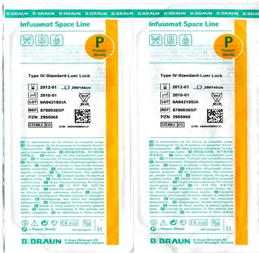
Figuur 2 Voorbeeld van label met een UDI op een primaire verpakking. Dit is de laatste verpakking die in contact staat met het product zelf. Het unieke productnummer, het lotnummer en de expiratedatum staan zowel in schrift als in een DataMatrix op het label:
